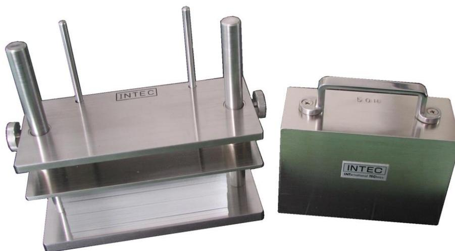
※試験片保持板のステンレス鋼製板（JIS L 0854 昇華に対する染色堅ろう度試験用）は、オプションとなっています。
